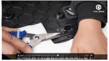
把附才拆下的盖板的原车脚窝灯 40.Replace the footwell light of the ambient light
