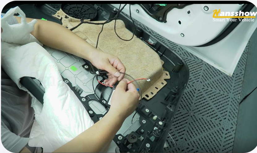
29. Disconnect the door wires
